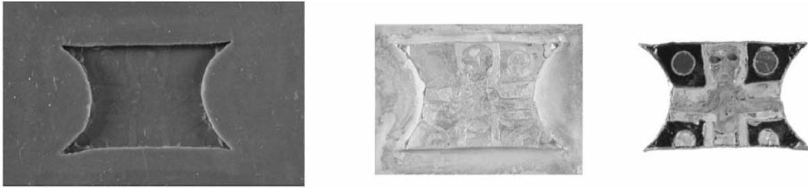
Figuur 6. Drie fasen bij het vervaardigen van de replica. Links de rubber mal die het goudemail in negatief weergeeft. In het midden de zilveren afvorming die in de rubber mal werd gemaakt. Rechts de afvorming met retouchering.
