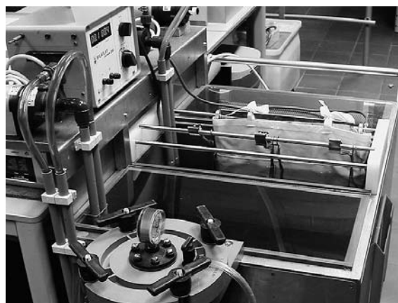
Figuur 7. De galvano-installatie die gebruikt werd bij het elektrolytisch kopiëren van het goudemail.
